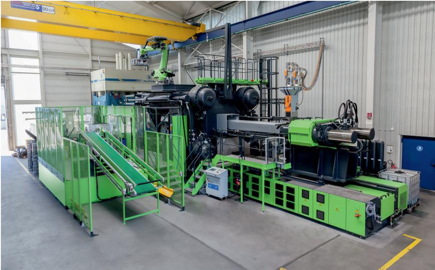
**Bild 3.** Die Versuche wurden im Technikum von Schneider Form auf einer Spritzgießmaschine Engel duo 23050/4000 durchgeführt (© Schneider Form)
